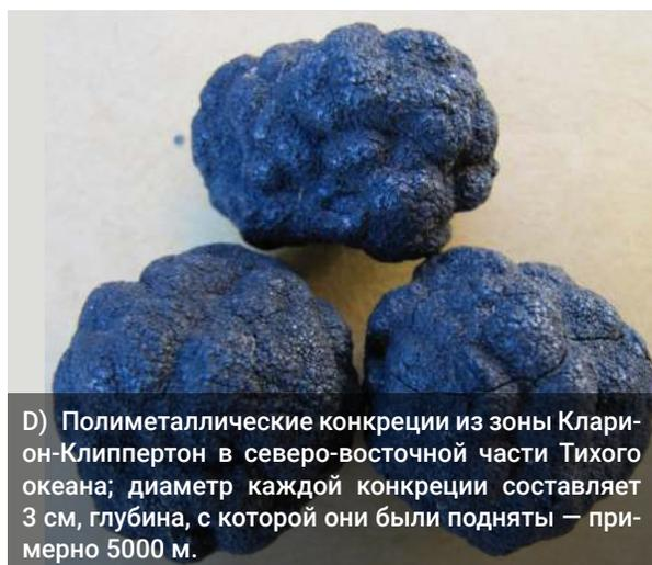
Д) Полиметаллические конкреции из зоны Кларин-Клиппертон в северо-восточной части Тихого океана; диаметр каждой конкреции составляет 3 см, глубина, с которой они были подняты — примерно 5000 м.
